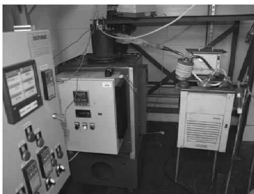
Rys. 5.53. Widok stanowiska badawczego pirolizy odpadów w skali do 1 kg
