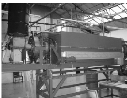
Rys. 5.29. Piec obrotowy do pirolizy zużytych opon (Letchworth, Anglia)
