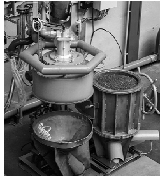
Rys. 5.40. Laboratoryjne stanowisko badawcze spiekania rud żelaza w Instytucie Metalurgii Żelaza (IMŻ)
