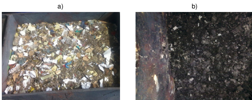
Rys. 5.47. Porównanie widoków wsadu poddanego pirolizie (a) oraz uzyskanego produktu stałego (b)
