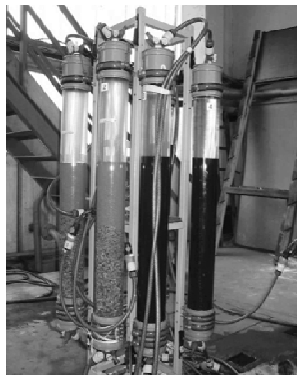
Rys. 5.36. Stanowisko badawcze adsorpcyjnego doczyszczania ścieków
