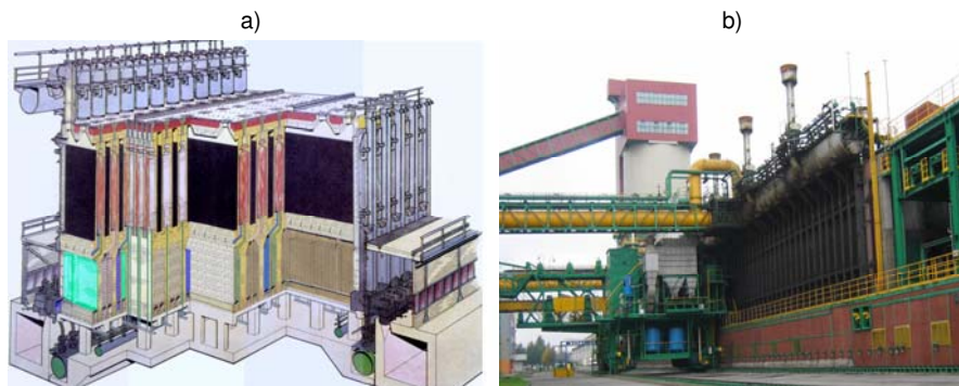
Rys. 5.51. Schemat (a) i widok (b) typowej baterii koksowniczej Fig. 5.51. Scheme (a) and view (b) of a typical coke oven battery Źródło: opracowanie własne
