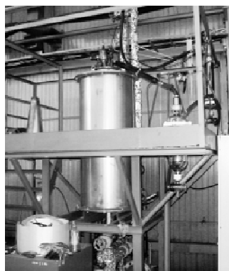
Rys. 5.27. Instalacja pirolizy i zgazowania paliw w złożu stałym (IChPW Zabrze)
