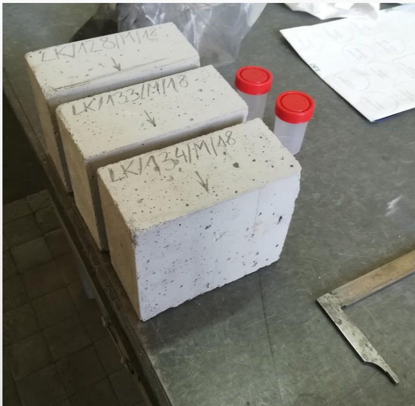
Próbki materiału ogniotrwałego przegetowane do badań laboratoryjnych
