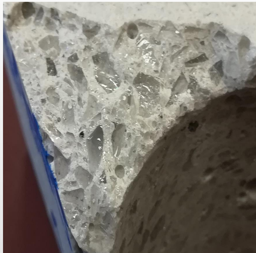
Przekrój materiału ogniotrwałego z widoczną krzemionką topioną
