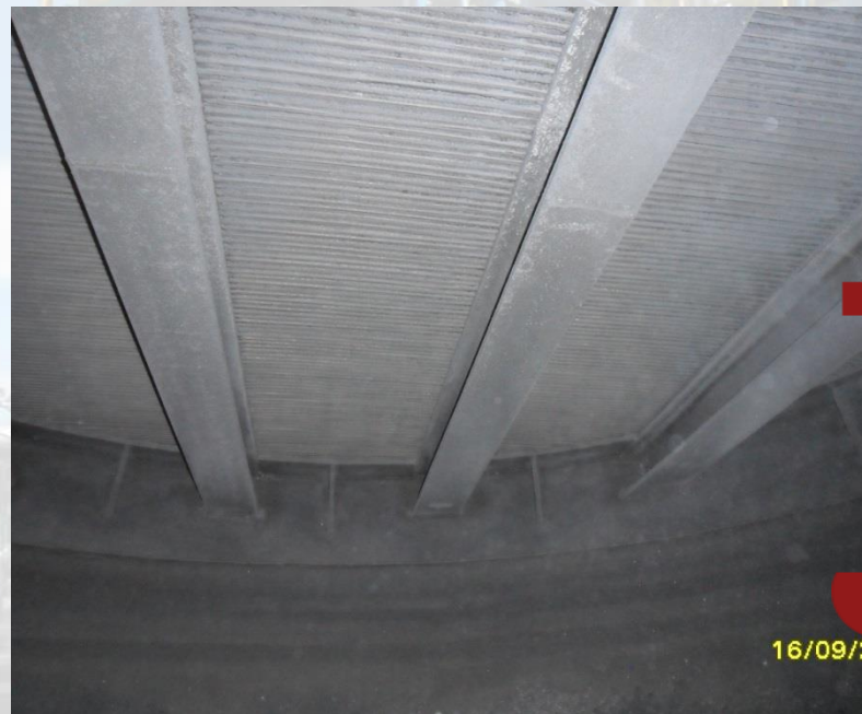
ruszt pod katalizator w reaktorze Clausa I.
