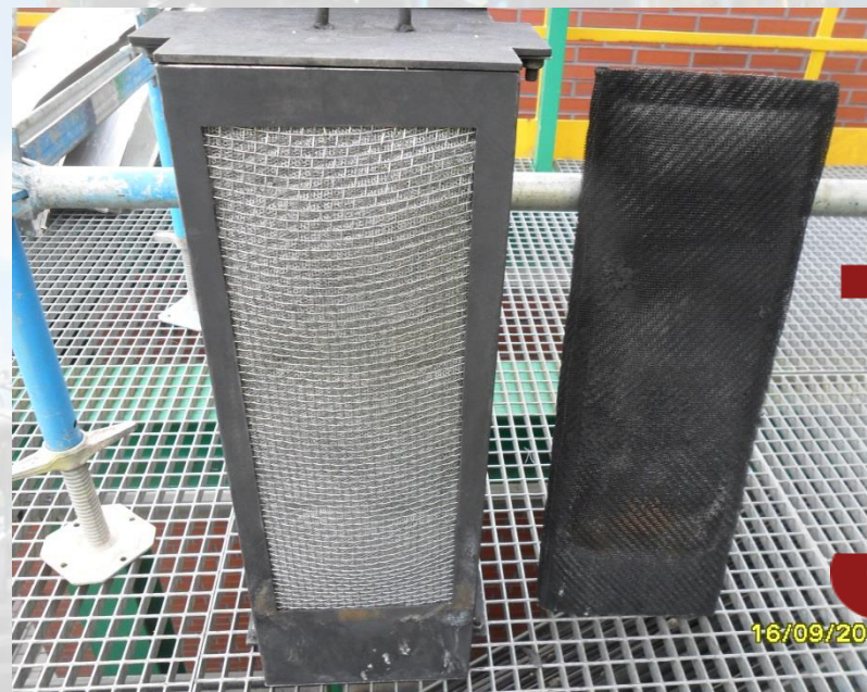
wkłady separatorów – nowy i używany
