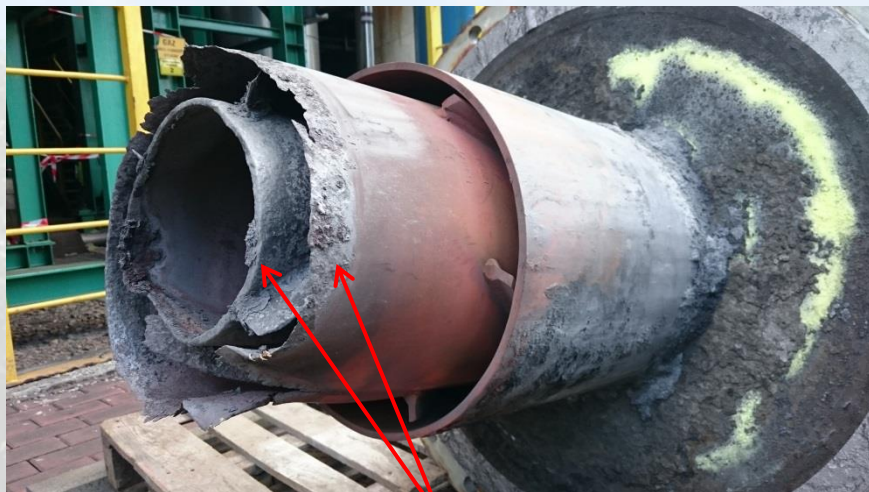
nadpalona końcówka palnika
